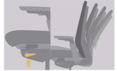
Sırt eğim açısı, 4 farklı kademedede ayarlanabilir. Toplam ayar aralığı 22°'dir.
